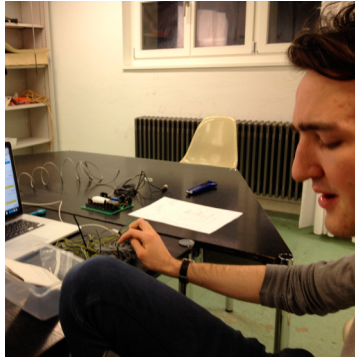
Tests. Schalter gelötet und verbunden.
